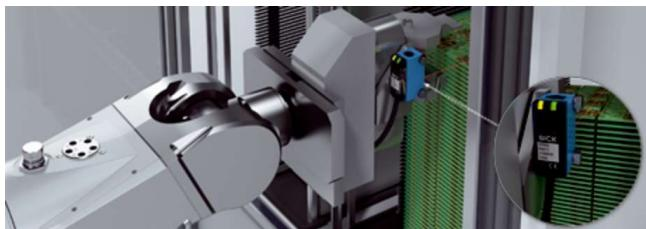
O portfólio do G6 a laser inclui sensores fotoelétricos com supressão do fundo e sensores fotoelétricos energéticos com alcance de 400 mm e diâmetro do ponto de luz de 0,4 mm. Por isso, o G6 a laser é perfeito para integração em braços de robôs e para uso em sistemas de tecnologia de automação.
